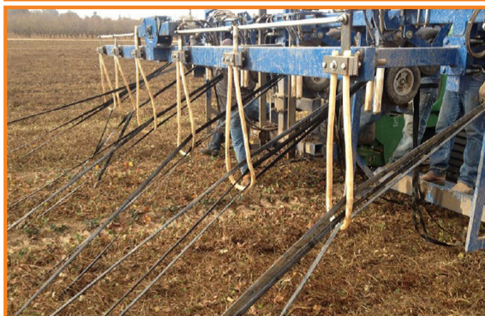
شکل ۱۱-تساویری از دستگاه جمع‌آوری‌کننده نوارهای تیپ از سطح مزرعه
