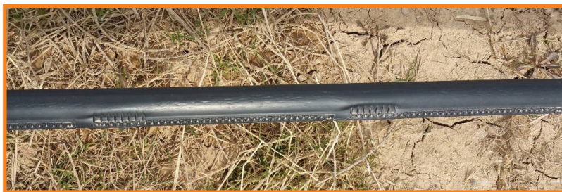
شکل ۶ - تصویری از لوله آبیاری تیپ که به اشتباه، روزنه‌ها رو به بالا قرار گرفته‌اند. توصیه می‌شود که روزنه‌ها به طرف خاک و رو به پائین قرار بگیرند
